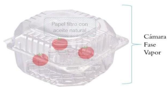
Figura 7. Ejemplo visual de la cámara de vapor usada en el experimento (Bahena, 2023).
