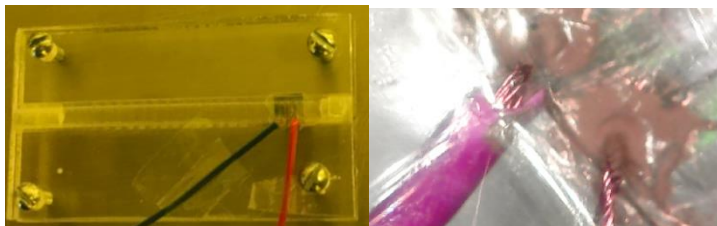
Figura 2. 16. Conexión de alambres de cobre con el sensor de microfluidos.
