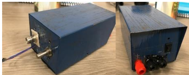
Figura 2. 20. Ensamble del circuito eléctrico en una caja de metal.
