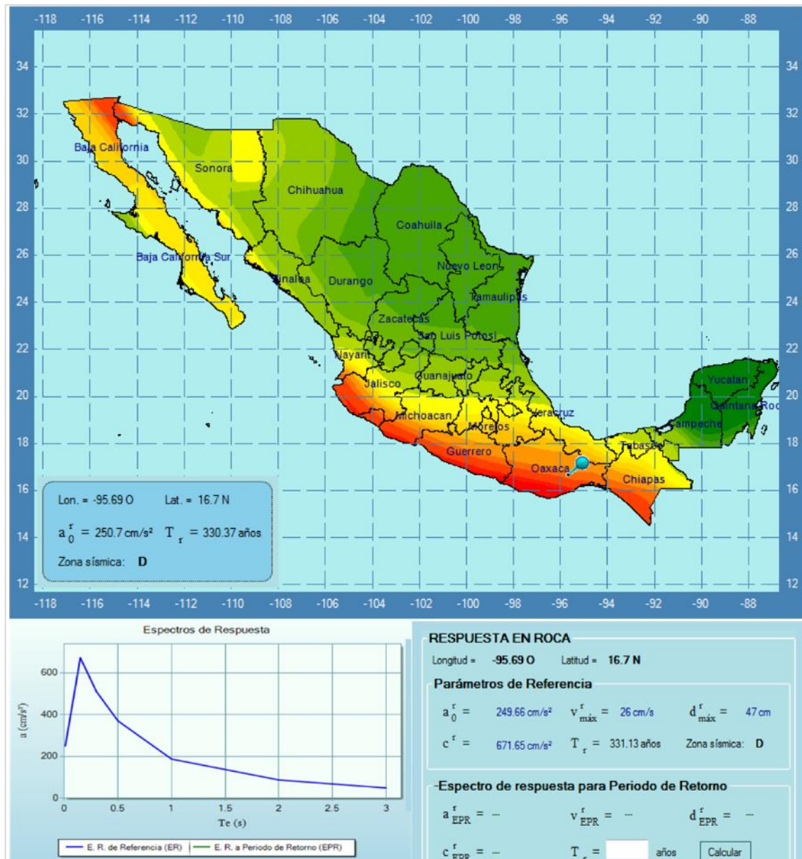
Figura 5.10 Regionalización de la República Mexicana y valores característicos del espectro sísmico.
