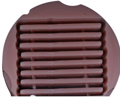
Figura 5 Disco de PMMA fresado para elaboración de barras
