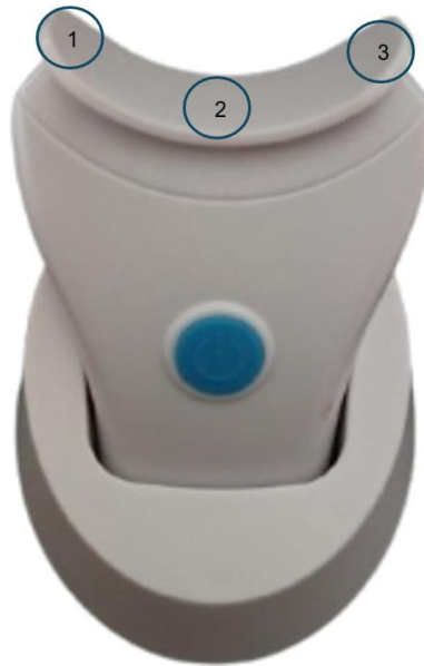
Figura 3: Muestra de los puntos a evaluar sobre el dispositivo de vibración.
