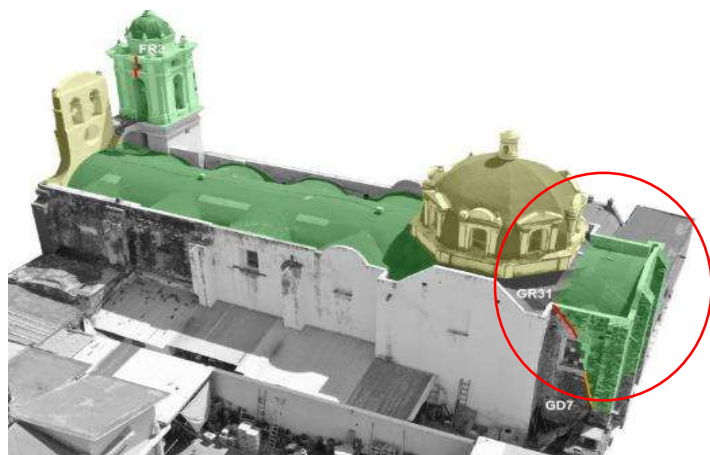
Ilustración 124: mecanismo de volteo del ábside. Autor: SLF
