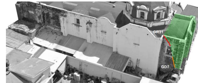
Ilustración 149: mecanismo de volteo en el ábside. Autor: SLF
