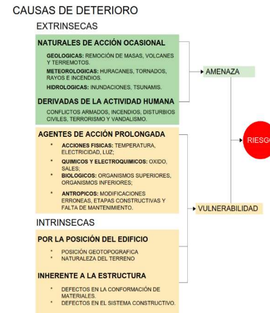
Ilustración 81: Causas de deterioro en el patrimonio edificado y el riesgo. Autor: SLF
