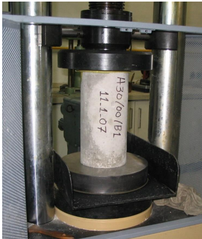
Figura 3.7 Ensayo de resistencia a compresión simple (UPM, 2011)
