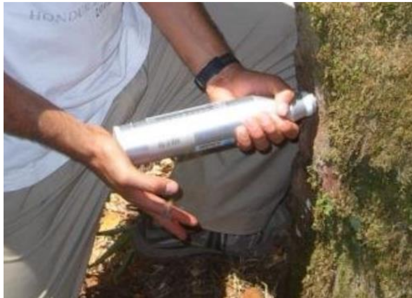
Figura 2.14 Ensayo in situ con el martillo Schmidt o esclerómetro (Mora, 2014)
