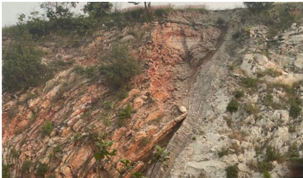
Figura 1.1 Falla en el macizo rocoso, cara norte, en Periférico Ecológico (Archivo personal)
