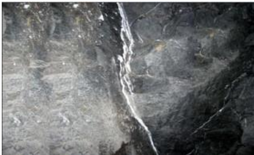
Figura 2.13 Discontinuidad rellena (Irveen, 2010)
