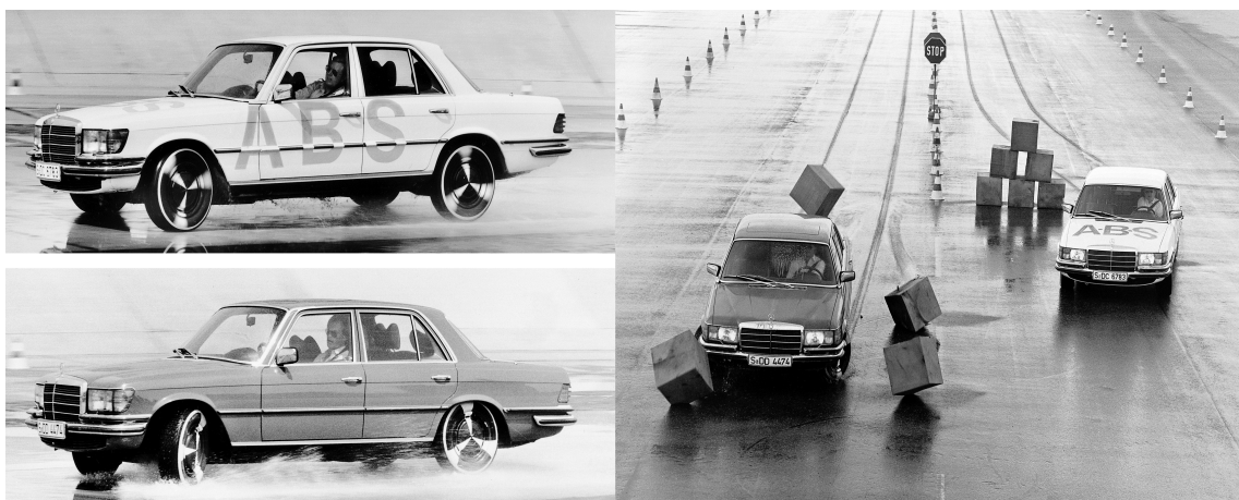
Figura 1: Prueba de manejo comparativa de la efectividad del ABS con unidad Mercedes-Benz Clase-S; fue un modelo producido desde 1972 hasta 1980 [1].
