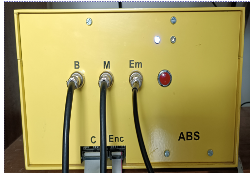
Figura 1.4: Fuente de poder vista desde el panel de conexiones (B=Brake; M=Motor; Em=Emergency; Enc=Encoder; C=Controller).
