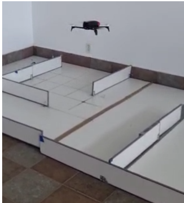
Figura 3.8: Cuadrirrotor en Hovering.
