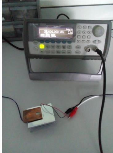
Figura 84: Sensor sometido a vibraciones mediante el piezoeléctrico excitado por un generador de funciones
