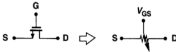
Figura 21: Modelo eléctrico del MOSFET en la zona de triodo
