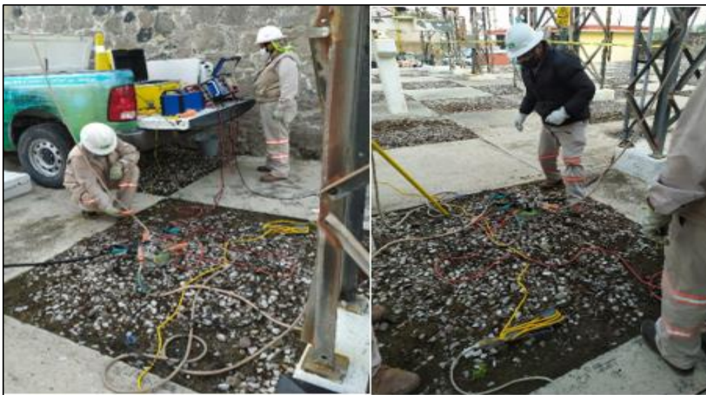
Fig. 4.1 Medición de impedancia de línea PQI-73030-JIL-STU con equipo CPC 100.
