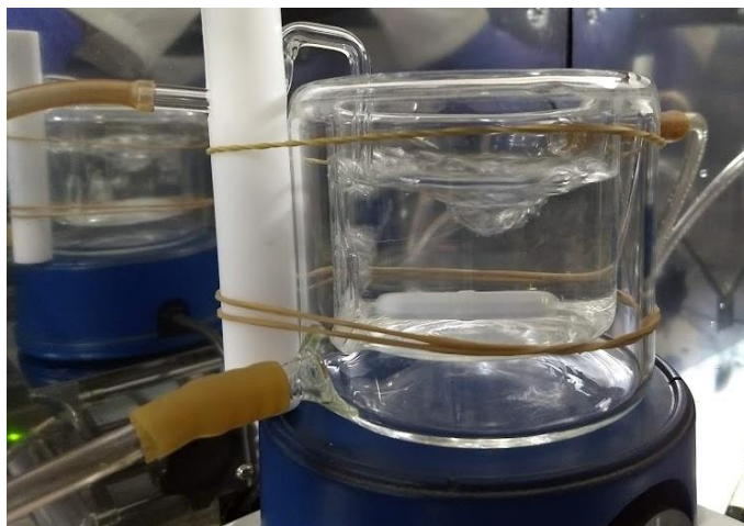
Figura 2.11. Sistema empleado en las pruebas de fotólisis, equilibrio Ads-Des y fotocatalisis bajo irradiación de luz visible y UV.
