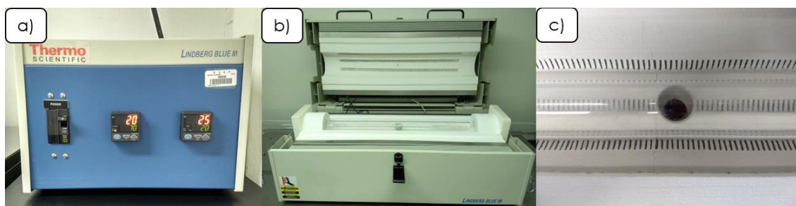
Figura 2.4. a) y b) controlador y horno tubular abierto respectivamente y c) crisol de cerámica con la muestra a tratar térmicamente dentro del tubo de cuarzo.
