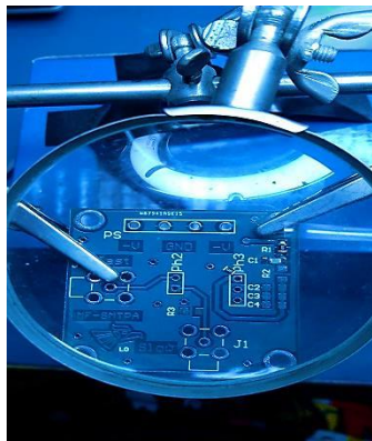
4. Soldar los componentes a la placa.
