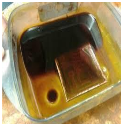
2. Corrosión del cobre que no se desea para grabar el diseño.
