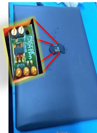
(4) Colocación del SiPM en el plástico centellador
