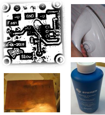
a) Plantilla del circuito, placa de cobre, ácido férrico y 1 plancha.
