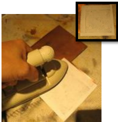
1. Adherir el diseño sobre la placa de cobre.
