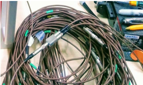
c) Cables de 10 ns, un divisor de señal y conectores tipo macho metálico.
