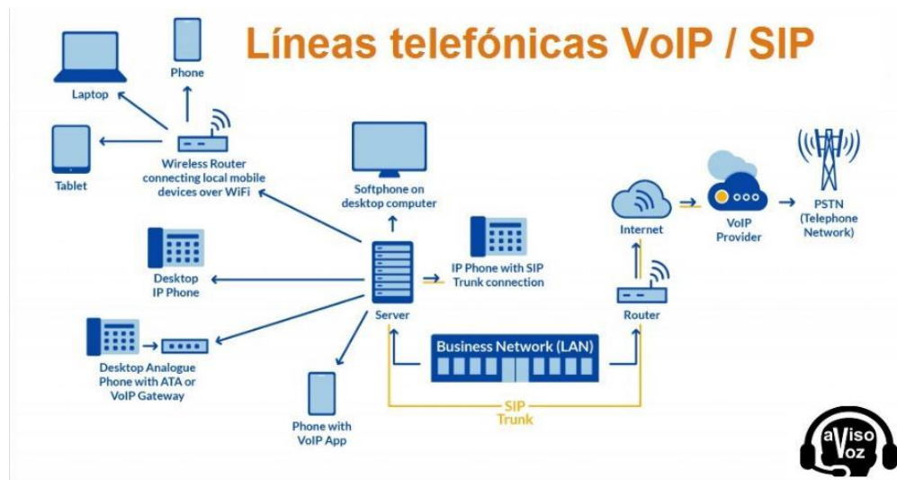
Figura 2.10 Algunos componentes para integrar llamadas SIP sobre VOZ IP. Recuperado de (Redacción Avisovozl, 2018).
