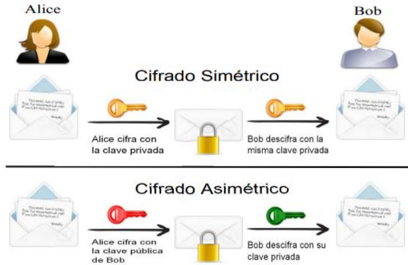
Figura 2.3.1: Diferencias entre criptografía simétrica y asimétrica.
