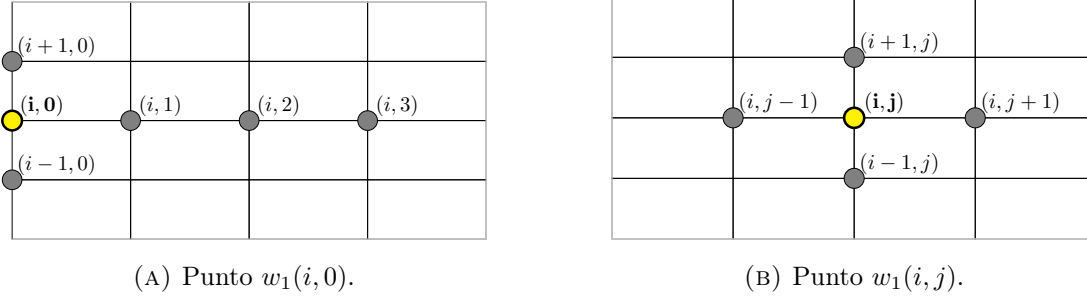
FIGURA 3.9: Representación de cómo se discretizaron los puntos interiores de w_1 , donde el punto amarillo es el que se discretiza y los puntos grises son sus vecinos.
