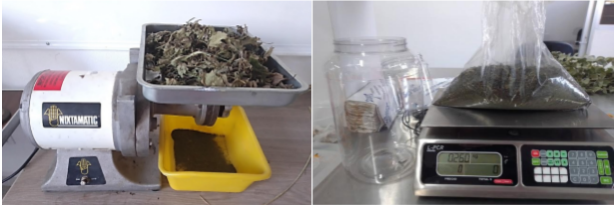
Figura 9. Material vegetal siendo pulverizado en molino eléctrico NIXTAMATIC; polvo vegetal pulverizado en la báscula.
