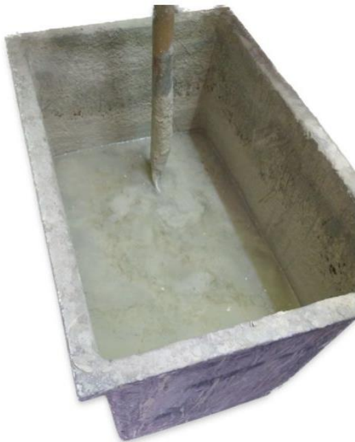
Figura 8. Tina con esmalte base. Fuente: Elaboración propia, 2025
