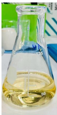
Figura 68. Vire de color amarillo con exceso de hidróxido de amonio 1M.
