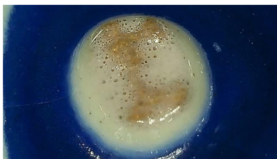
Figura 65. Pieza con porosidad y craquelado.
