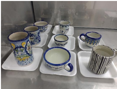
Figura 26. Piezas terminadas durante el análisis de absorción de agua
