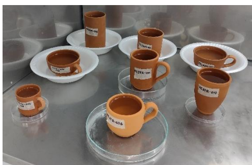
Figura 24. Piezas de jahuete durante el análisis de absorción de agua.
