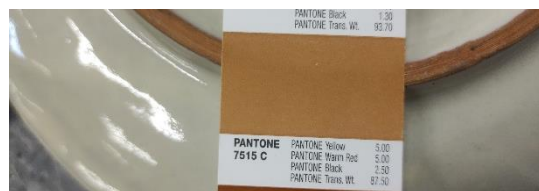
Figura 16. Cuerpo cerámico de pieza terminada con un numeral de Pantone correspondiente.
