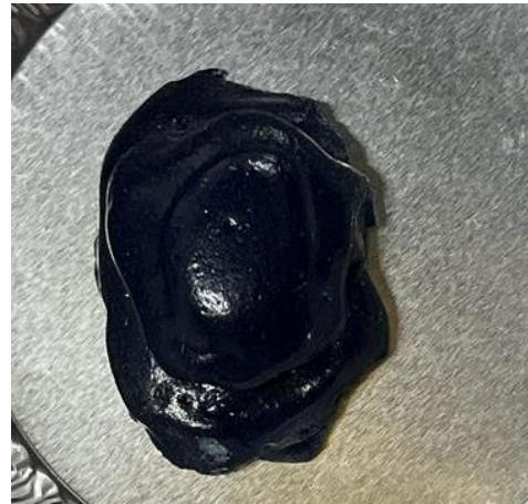
Figura 37. Gota de pintura azul cobalto después del horneado y desmoldada del jahuete.
