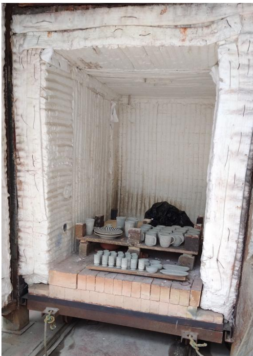
Figura 11. Piezas de Talavera dentro del horno, acomodadas en estibas de manera para su segunda cocción. Fuente: Elaboración propia, 2025.
