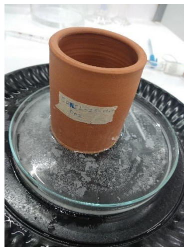
Figura 25. Pieza de jahuete después del análisis de absorción de agua.
