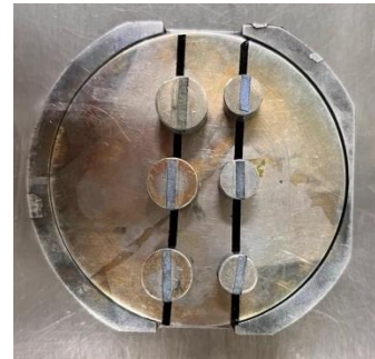
Figura 58. Muestras de pintura en polvo de azul cobalto, montada sobre cinta doble cara y en el disco de análisis.
