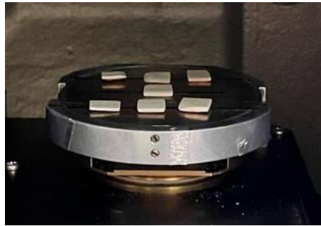
Figura 59. Piezas montadas en disco de análisis para estudio de la zona superficial.
