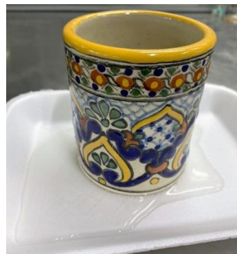
Figura 27. Pieza terminada durante el análisis de absorción de agua
