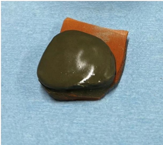
Figura 36. Gota de pintura azul cobalto antes del horneado.
