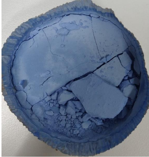
Figura 13. Pintura azul cobalto antes del horneado, con tratamiento térmico a 110°C durante 12 horas.
