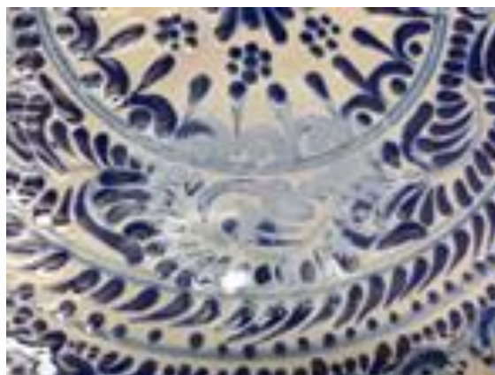
Figura 73. Plato del taller 6 después de la prueba de corrosión con HF al 30% a simple vista se observa desgaste del esmalte base y del azul cobalto (aunque no en su totalidad).
