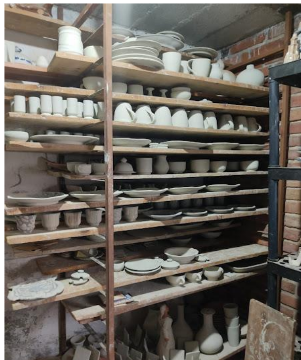
Figura 7. Cuarto de secado, previo al segundo horneado. Taller Talavera Celia. Fuente: Elaboración propia, 2025.
