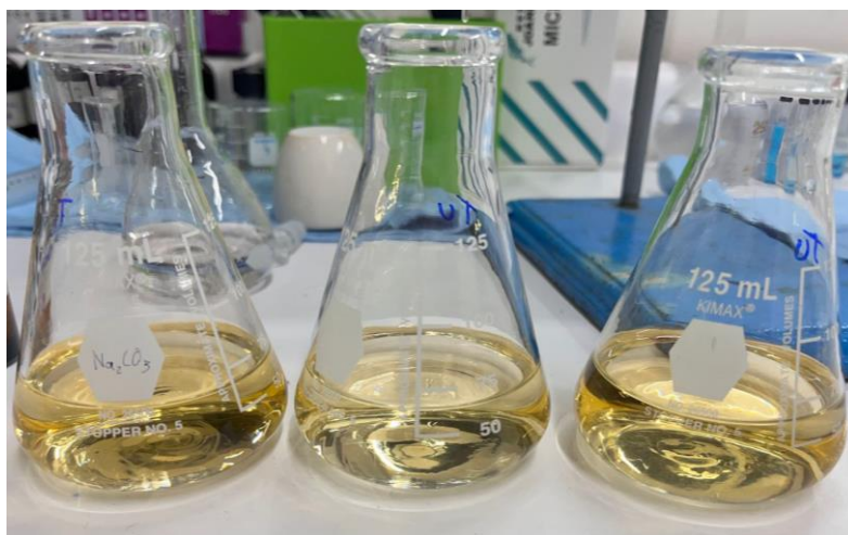
Figura 31. Vire amarillo del indicador murexida en la solución de cobalto, con \text{NH}_4\text{OH}
