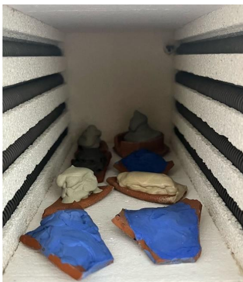
Figura 35. Muestras de azul cobalto antes del tratamiento térmico.
