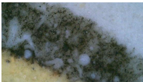
Figura 21. Borde esmaltado de aspecto difuso, visto desde el microscopio digital.
