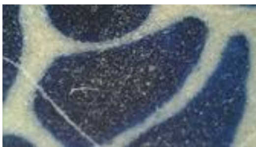
Figura 72. Área del plato del taller 3 (Figura 71) vista bajo el microscopio, apreciable corrosión al esmalte base, pero no al azul cobalto.
