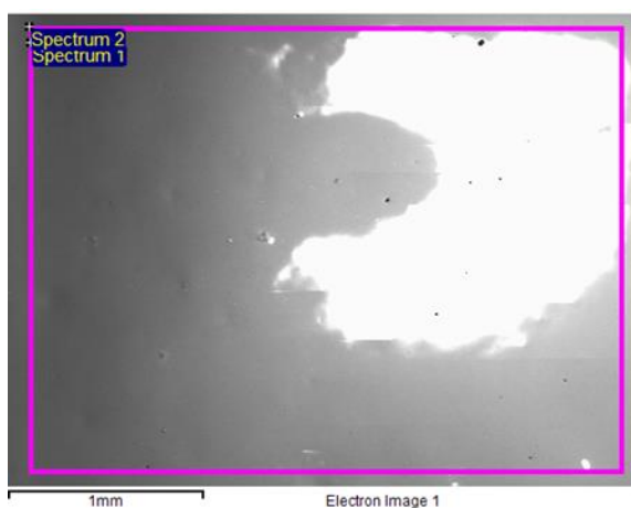
Imagen 10. Espectroscópica del estudio de EDS, con las regiones de interés analizadas. Zona superficial
