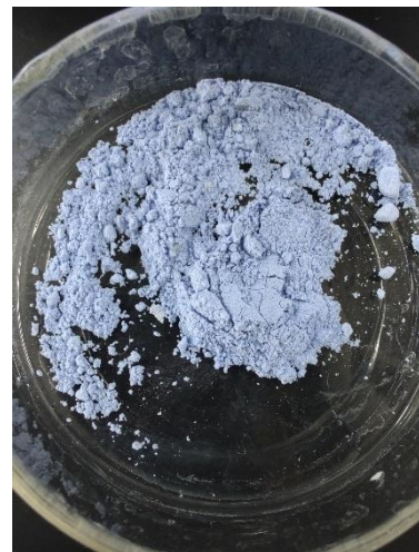
Figura 38. Polvo de azul cobalto después del tamizado.
