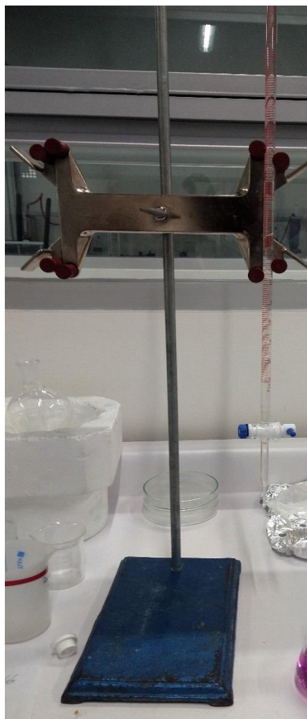
Figura 30. Sistema armado de valoración volumétrica (Soporte universal, pinza para buretas y Bureta de 25 ml)
