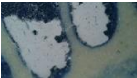
Figura 74. Área del plato del taller 6 (Figura 73) vista bajo el microscopio, se aprecia en su totalidad la eliminación del esmalte base y el azul cobalto, pero no es apreciable el cuerpo cerámico.
