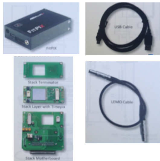
FIGURA 36 PARTES DEL DETECTOR TIMEPIX
