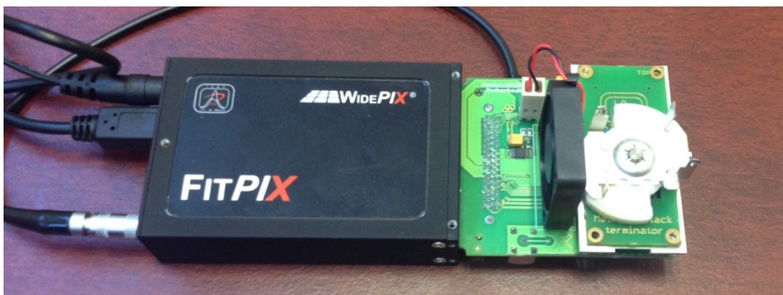
FIGURA 37 DETECTOR TIMEPIX YA CONECTADO A TODOS SUS COMPONENTES
