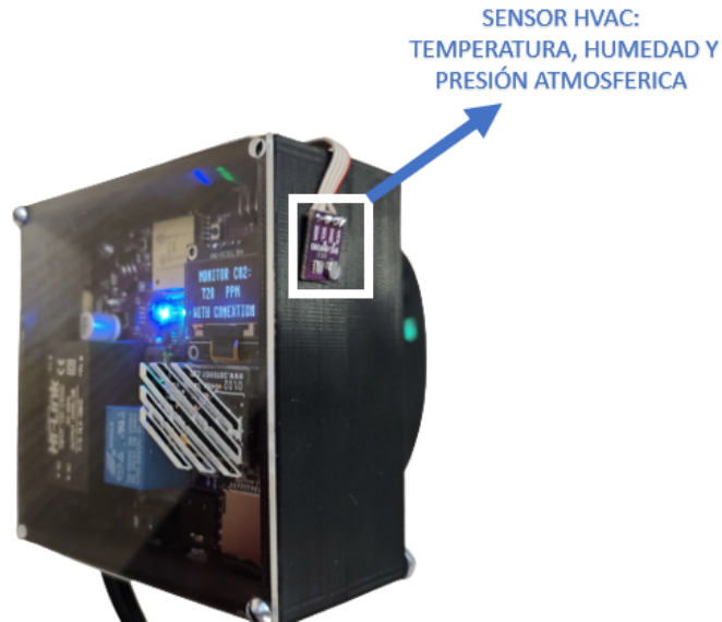
Figura 4.3: Colocación del sensor añadido.
