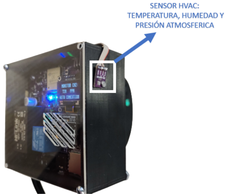
Figura 3.28: Colocación del sensor.
