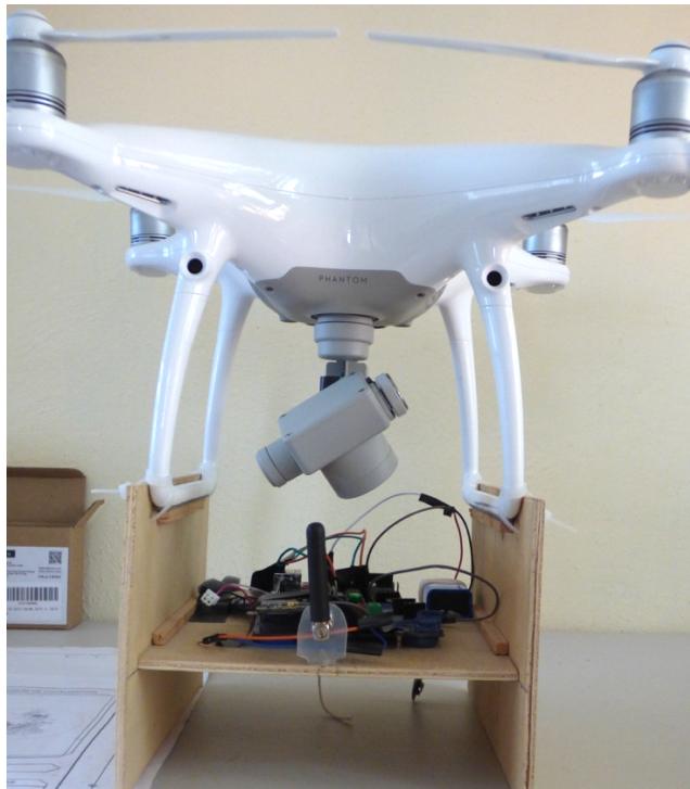
Figura 84 Vista del UAV con el sistema de monitorización acoplado
