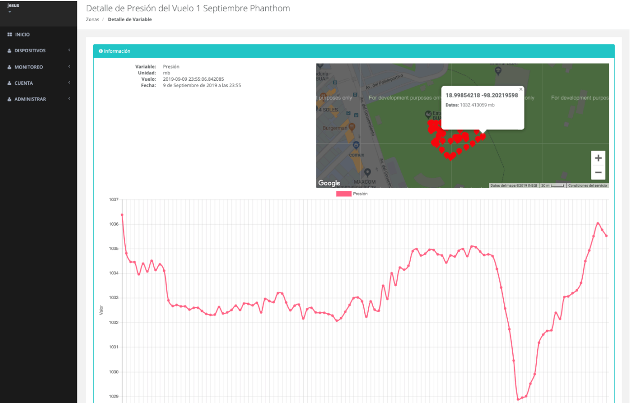
Figura 91 Detalle de variable de vuelo (Presión atmosférica), se puede observar el mapa de muestras y grafica vs tiempo
