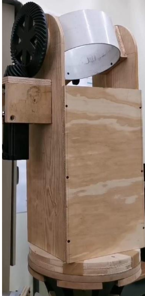
Figura 45 Ensamblaje de toda la estructura con las piezas fabricadas en madera
