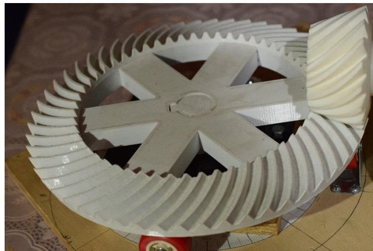
Figura 20 Engranaje conducido (rueda) impresa en su totalidad
