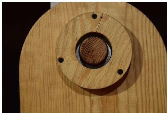
Figura 51 cajas de alojamiento de rodamiento elaboradas en madera
