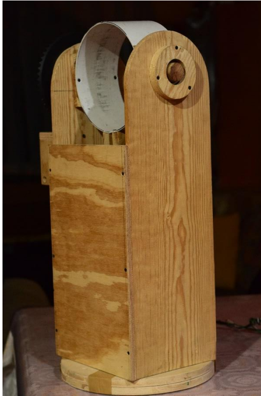
Figura 42 Modelo de los brazos dobsonianos fabricados en madera
