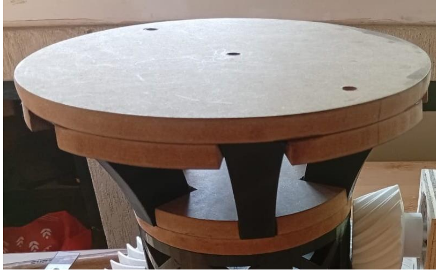
Figura 40 Base cónica truncada invertida ensamblada con sus 6 catenarias.
