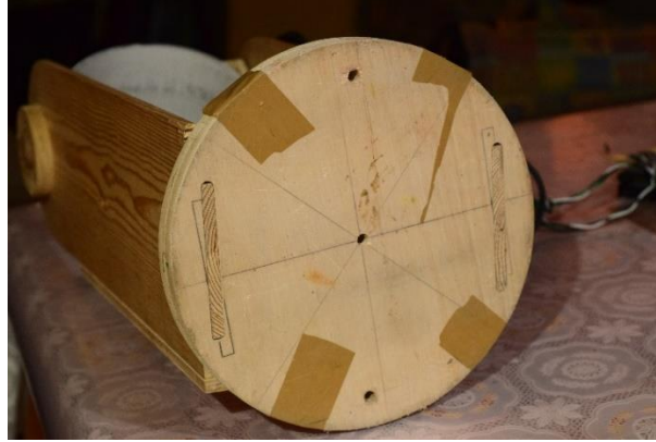
Figura 44 Modelo de la base de acoplamiento fabricada en madera
