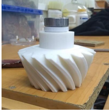
Figura 22 Engranaje conductor (piñón) impreso en su totalidad
