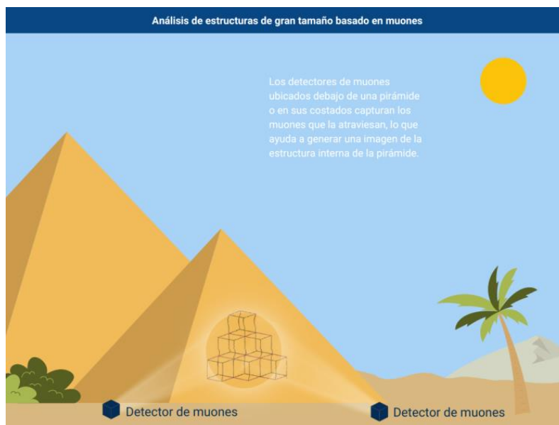
Figura 2 Imagenología muónica de una pirámide mediante dos detectores.
