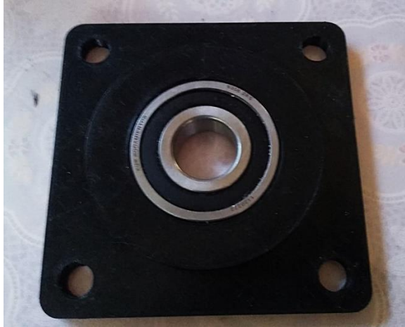
Figura 24 Base giratoria impresa y ensamblada
