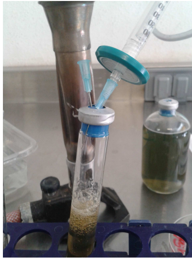
Figura 5.5: Desgasificación de tubo Hungate ® .
