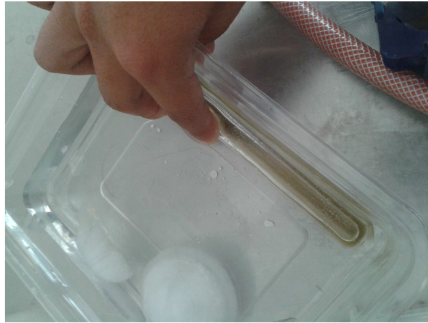
Figura 5.6: Enfriamiento de tubo Hungate ® mediante el rodado dentro de un recipiente con hielo.
