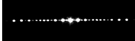
Figura 3.10. Órdenes de difracción dados por ambas ventanas en el plano de Fourier,
