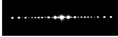
Figura 2.5. Órdenes de difracción dados en el plano de Fourier
