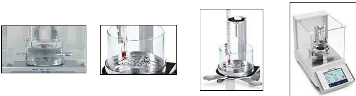
Figura 8. Balanza con accesorios para medir la densidad de las membranas.
