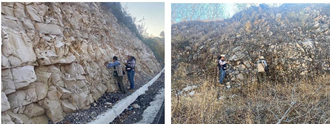
Figura 5.3. Medición de planos de falla y de fracturas realizados en la carretera Tuxtla Gutiérrez–San Cristóbal de las Casas.
