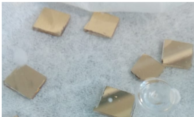
Figura 3.1.6. Sustratos de vidrio con película de oro.
