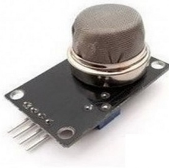
Figura 4.11: Sensor de Calidad de Aire
