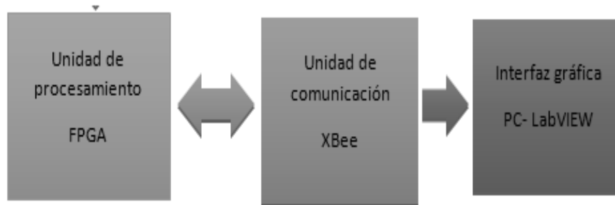
Figura 3.11: Diagrama a bloques de la estación de monitoreo
