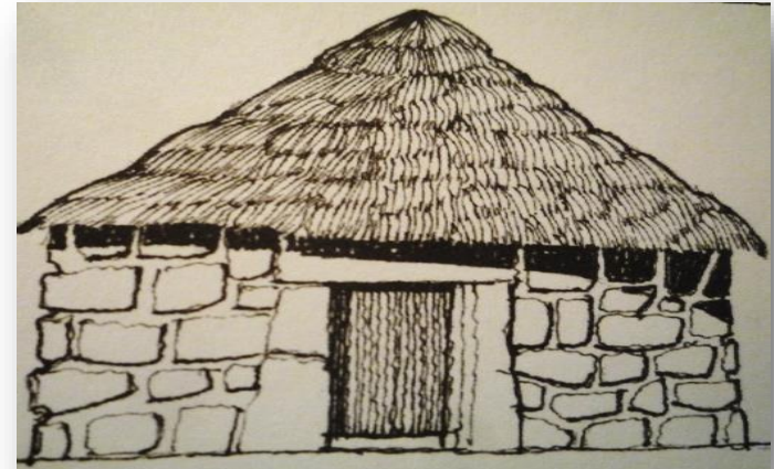
Imagen 52: Primeras Cabañas de piedra y paja; utilización de muros de mamposteó a través de los primeros morteros, dinteles en puertas y ventas.
