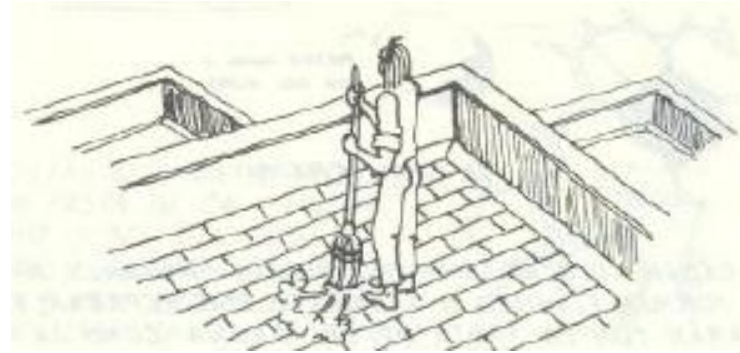
Imagen 113: Detalle de elaboración y aplicación de impermeabilizante a base de cal.
