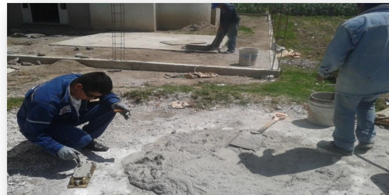
IMAGEN 30: TOMA DE MUESTRAS DE ENSAYES DE MORTERO A BASE DE CAL - ARENA.
