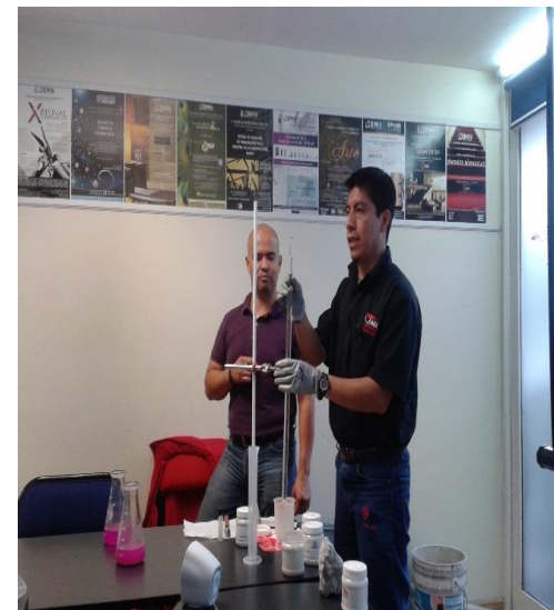
IMAGEN 28,29 Y 30: PRUEBA DE DISPONIBLE DE LA CAL CON AGUA DESTILADA, INDICADOR AZUCARADO EN UN ENSAYE QUÍMICO.
