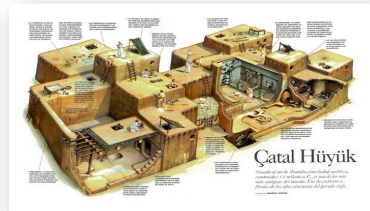
Imagen 59 Y 60: Se muestra Isométricos de Vivienda de CATAL HÜYÜL; donde se puede apreciar el sistema constructivo que integra una vivienda de esta civilización.
