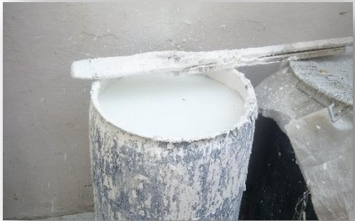
IMAGEN 36: MUESTRA DE LA PREPARACIÓN DE LA BABA DE NOPAL ANTES DE SU APLICACIÓN CON LA PINTURA A LA CAL.
