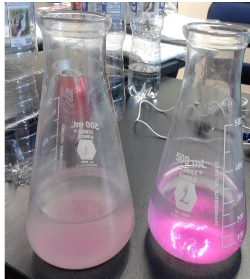
IMAGEN 28,29 Y 30: PRUEBA DE DISPONIBLE DE LA CAL CON AGUA DESTILADA, INDICADOR AZUCARADO EN UN ENSAYE QUÍMICO.
