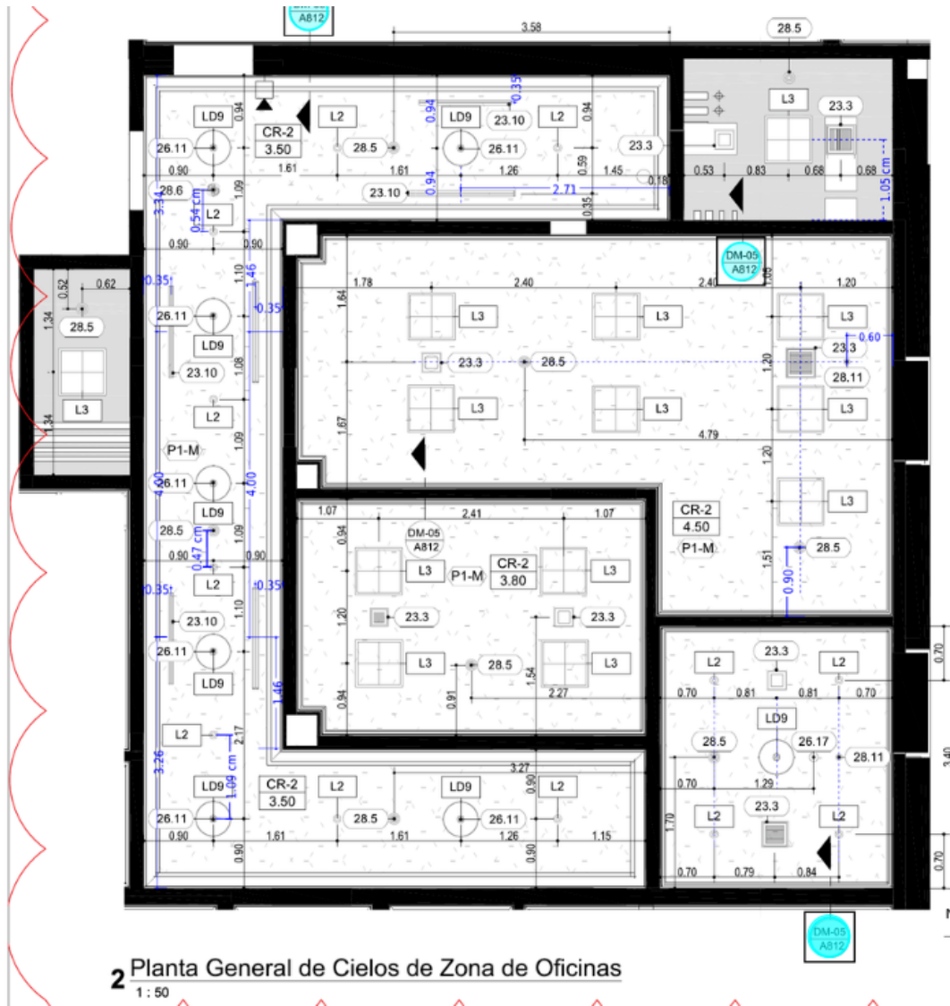
Imagen 4.21 Plano arquitectónico de distribución de accesorios de plafón liso Recuperado de procore.com
