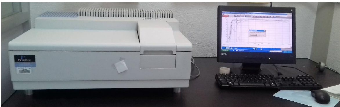
Figura 2.7 Espectrofotómetro UV-Vis Lambda 35, Perkin Elmer.
