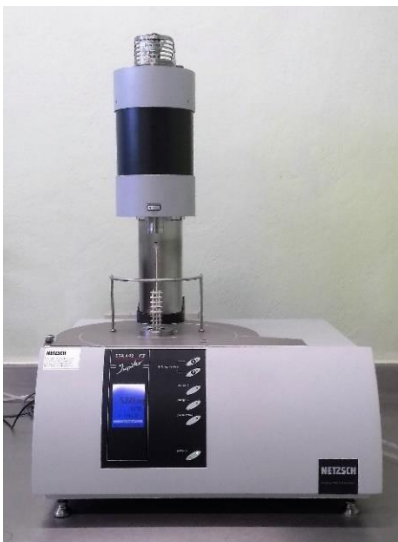
Figura 2.3 Equipo empleado para el análisis termogravimétrico, NETZSCH modelo STA 449 F3.
