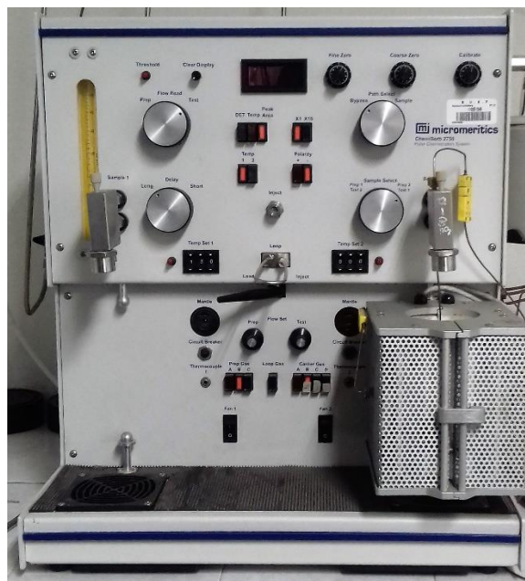
Figura 2.4 Equipo empleado para el cálculo del área específica, Chemsorb 2750.
