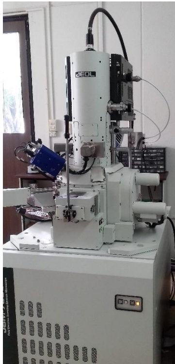
Figura 2.6 Microscopio con haz de electrones JSM-7800F empleado para la obtención de las microscopías y el análisis elemental.
