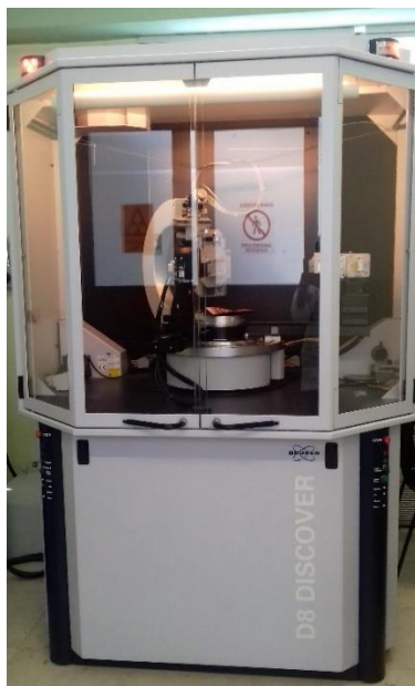
Figura 2.2 Equipo de difracción de rayos X, Bruker D8 DISCOVERY.
