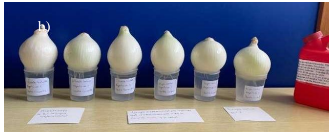
Figura 51. Experimentos finales de ensayo de toxicidad utilizando Allium cepa , a) Efluente sin tratar, b) Efluente tratado con fotocátalisis utilizando \text{TiO}_2/\text{SiO}_2
