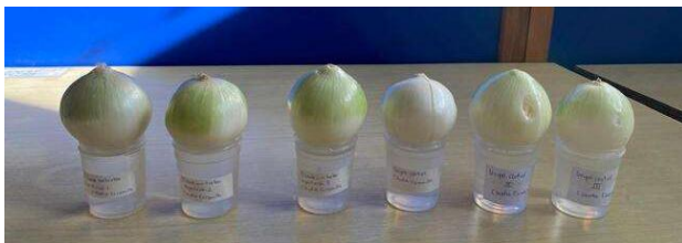
Figura 50. Experimentos iniciales de ensayo de toxicidad utilizando Allium Cepa . a) Efluente sin tratar, b) Efluente tratado.
