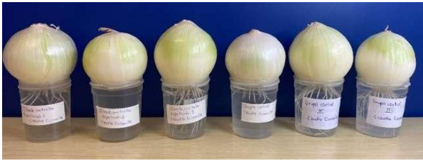
Figura 51. Experimentos finales de ensayo de toxicidad utilizando Allium cepa , a) Efluente sin tratar, b) Efluente tratado con fotocátalisis utilizando \text{TiO}_2/\text{SiO}_2
