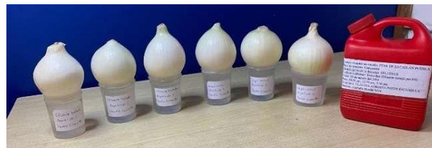
Figura 50. Experimentos iniciales de ensayo de toxicidad utilizando Allium Cepa . a) Efluente sin tratar, b) Efluente tratado.
