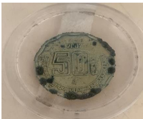
Figura 14. Cristales obtenidos a partir de una moneda de cobre
