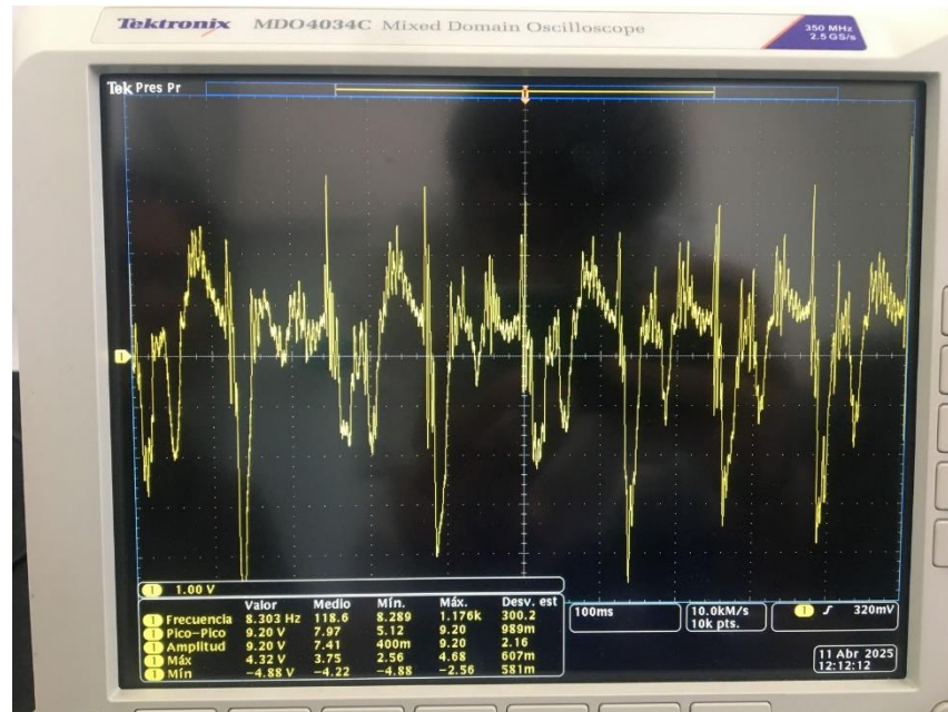
Figura 3.25 Fotografía tomada de los resultados obtenidos del transductor piezoeléctrico S118-J15S-1808YBM con un resorte implementado y peso en el extremo voladizo del sensor
