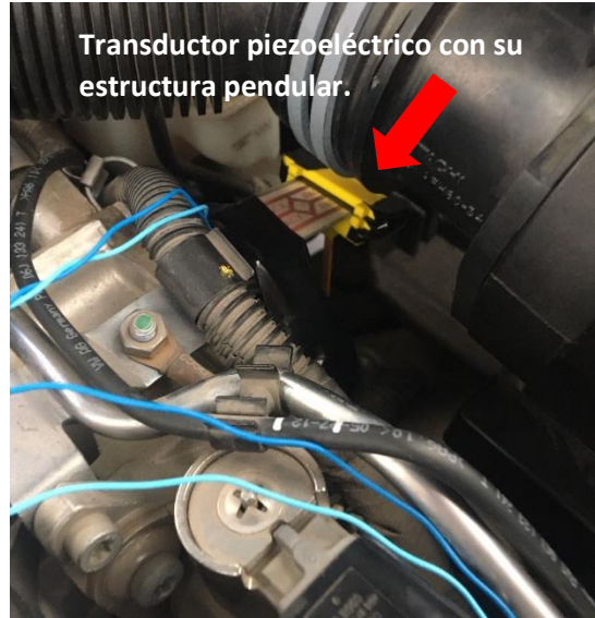
Figura 4.2 Fotografía de la colocación del transductor piezoeléctrico con el sistema pendular acoplado a su extremo libre, en una parte del motor del vehículo de pruebas Beetle
