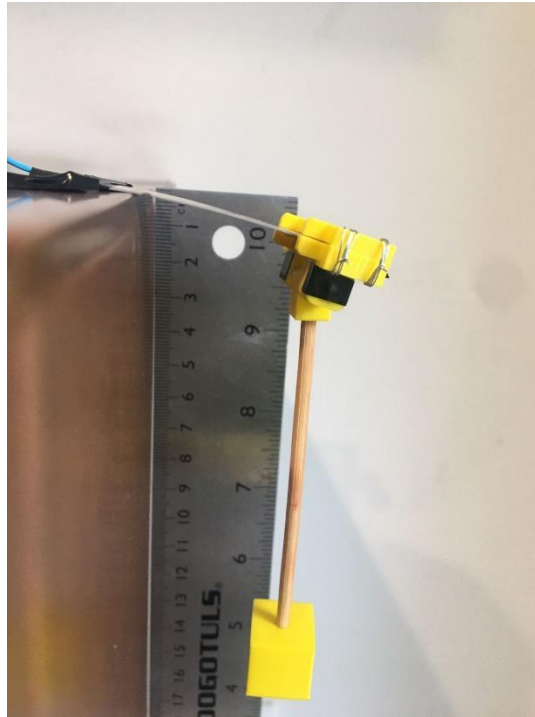
Figura 3.31 Deflexión mostrada por el transductor piezoeléctrico cuando se le fue colocado el sistema pendular
