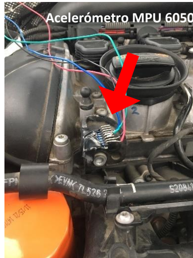
Figura 3.2 Acelerómetro MPU 6050 colocado en una parte del motor del vehículo de pruebas Beetle.
