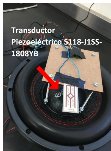
Figura 3.19 Fotografía tomada del transductor piezoeléctrico S118-J1SS-1808YBM montado en la bocina para la realización de las pruebas de vibración
