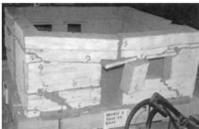
Imagen 65 (Minke, 2001) Fallas en maqueta de adobe en simulación de sismo. Se explican las fallas por
