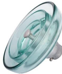
Figura 22. Características de los aisladores de vidrio. 25–Diámetro del disco, S–Suspensión, V–Material vidrio, C–Acoplamiento calavera, 111–Resistencia mecánica, C–Corrosión.
