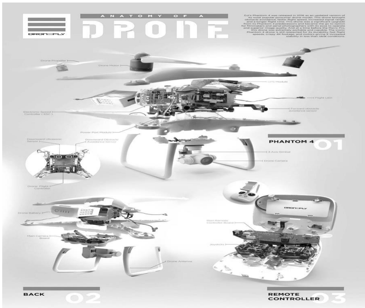
Figura 38. Fotografías de los componentes de un dron DJI PHANTOM.
