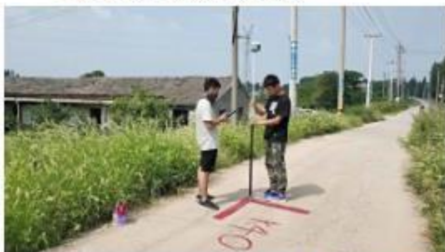
Los topógrafos están marcando la esquina, no el centro de la L. Este gran proyecto utilizó 160 GCP y puntos de unión.
