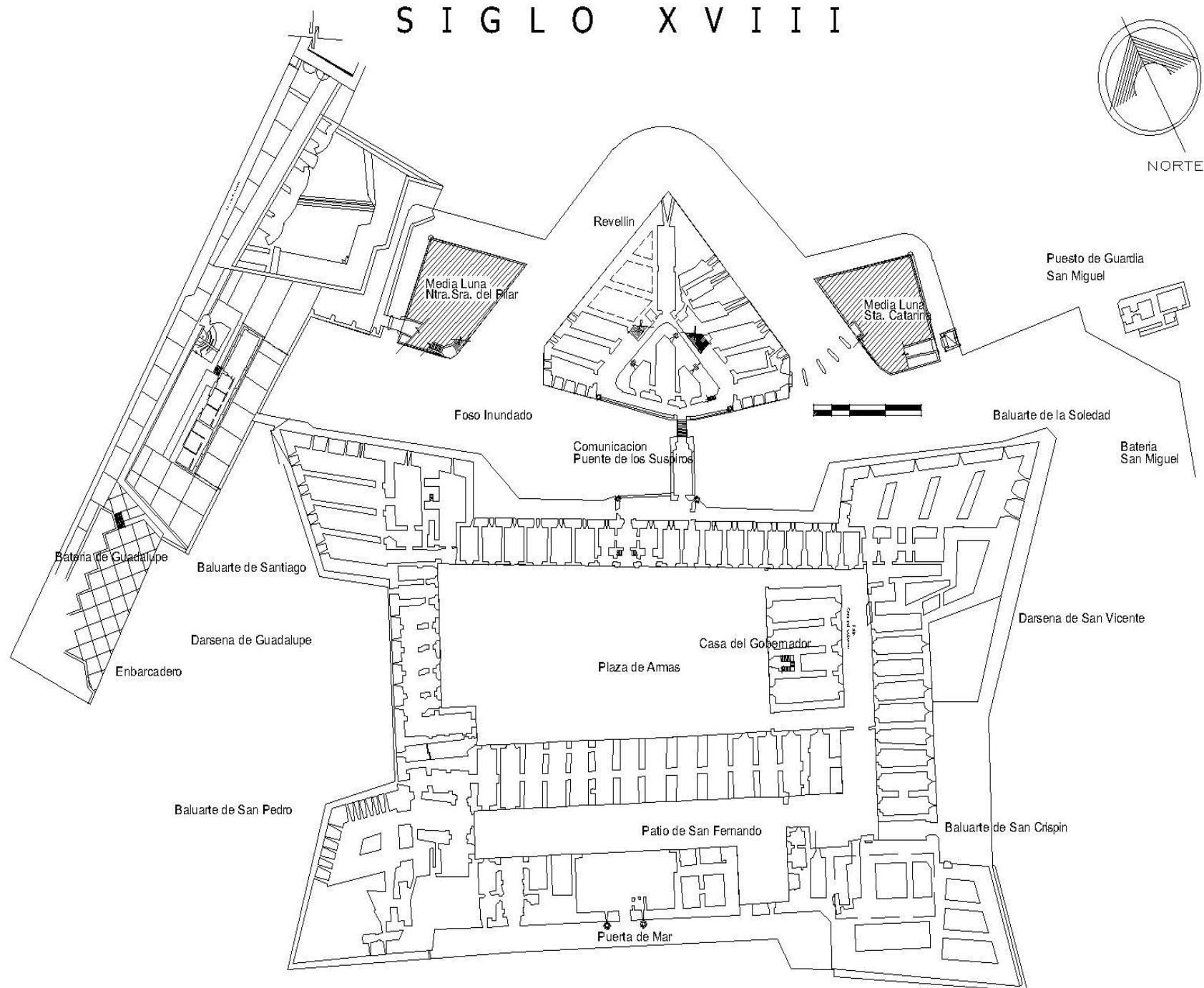
Fig. 17 Proceso constructivo de 1778, obras por Miguel del Corral en el cual propone lunetos llamados nuestra Señora del Pilar y Santa Catarina. Edito plano: Arq. Angelina del Carmen González Díaz. 2015
