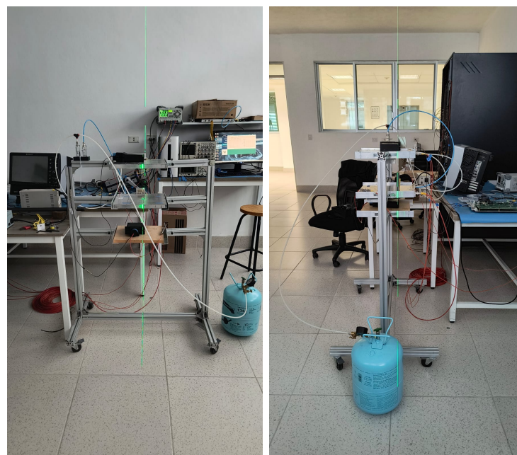
Figura 4.13: Arreglo experimental en las figuras se puede observar la base metálica junto con la alineación utilizando un láser.
