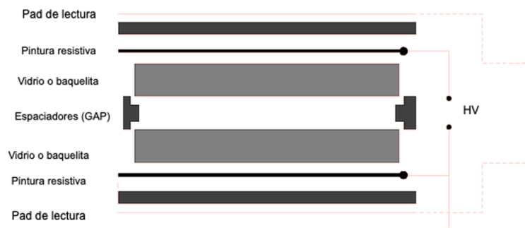
Figura 2.1: Diagrama de las partes de un detector RPC
