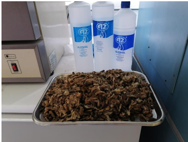
Figura 17.- Colillas limpias, extendidas creando filamentos finos para la dispersión del concreto (Elaboración propia)
