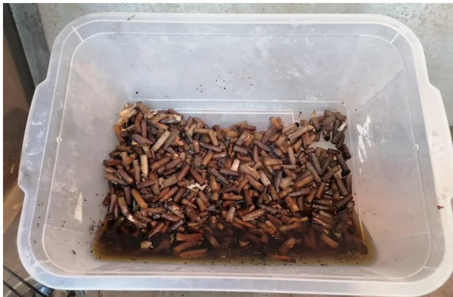
Figura 14.- etapa de lavado a base de etanol al 70% (Elaboración propia).
