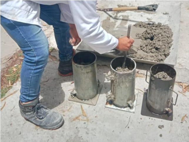
Figura 50.- Elaboración y curado (NMX-C-123-ONNCCE-2012).
