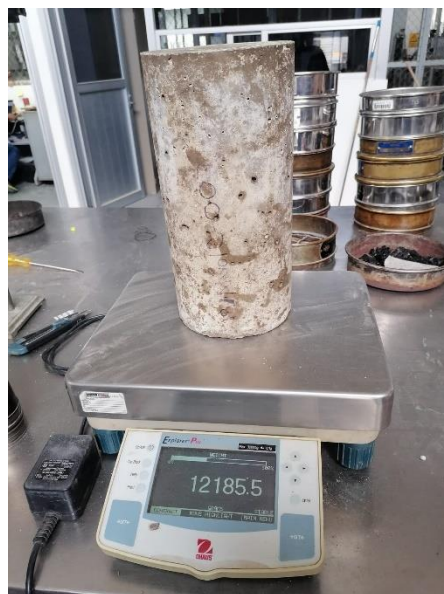
Figura 55.- Peso del cilindro sin colillas (NMX-C-123-ONNCCE-2012).
