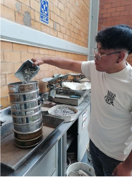
Figura 27.- Tamizado de la grava.
