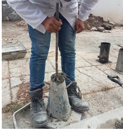
Compactación del concreto.
