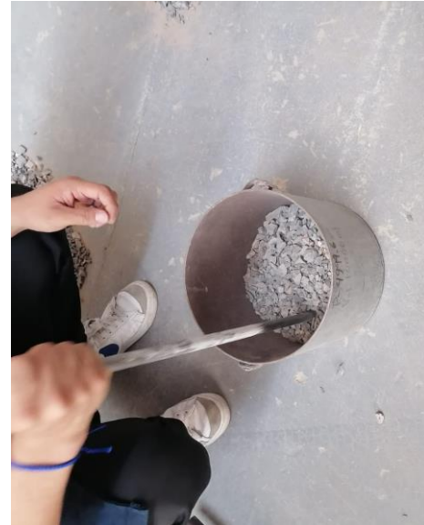
Figura 26.- Análisis para el peso volumétrico seco varillado (P.V.S.V).
