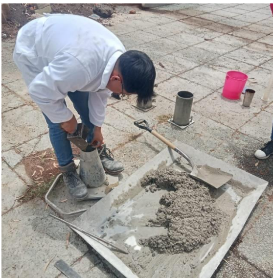
Figura 47.- Agregado de del material al cono.
