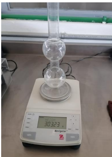
Figura 38.- Pesaje del matraz
