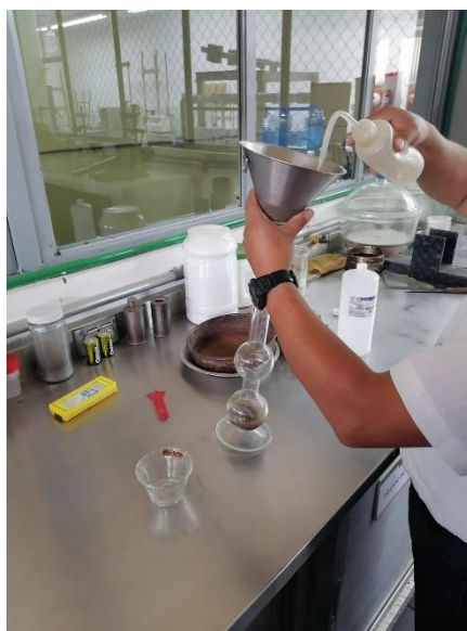
Figura 39.- Llenado del matraz.
