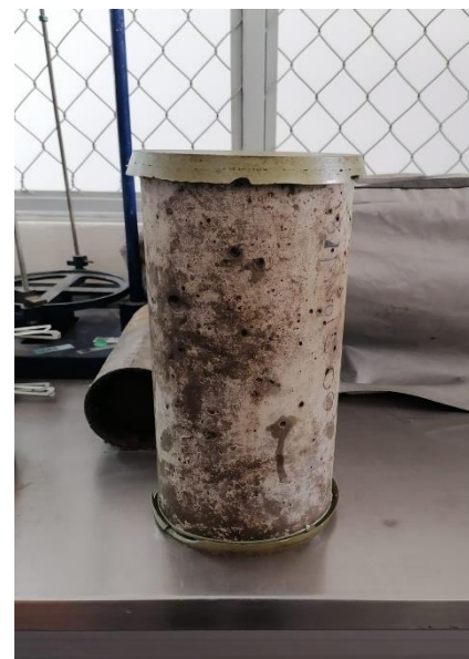
Figura 57.- Resultado final del cabeceo (NMX-C-123-ONNCCE-2012).
