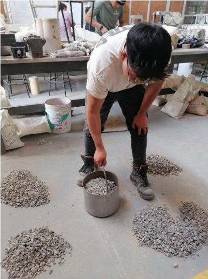
Figura 25- Análisis para el peso volumétrico seco compacto (P.V.S.C).
