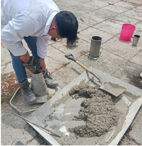
Introducción del concreto al cono.
