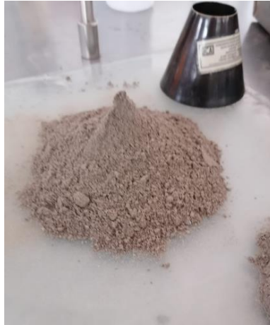
Figura 35.- Cono de arena para determinar su densidad.
