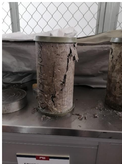
Figura 61.- Modo de falla (Cilindro son colillas al 3%).
