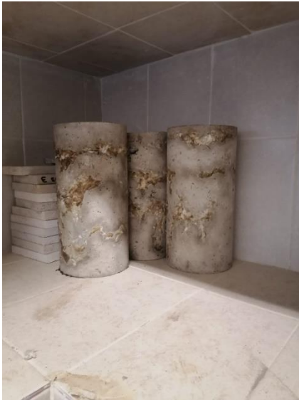
Figura 62.- Especímenes al 2% de colillas alterados.
