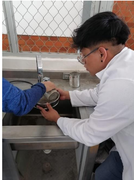
Figura 33.- Lavado del material (Arena).
