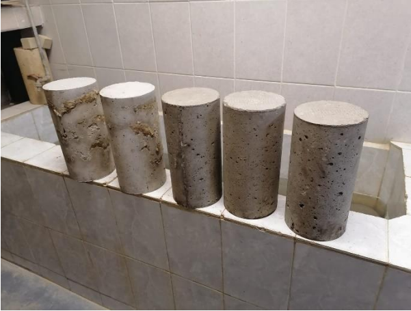
Figura 53.- Almacenamiento y control de los cilindros de concreto.
