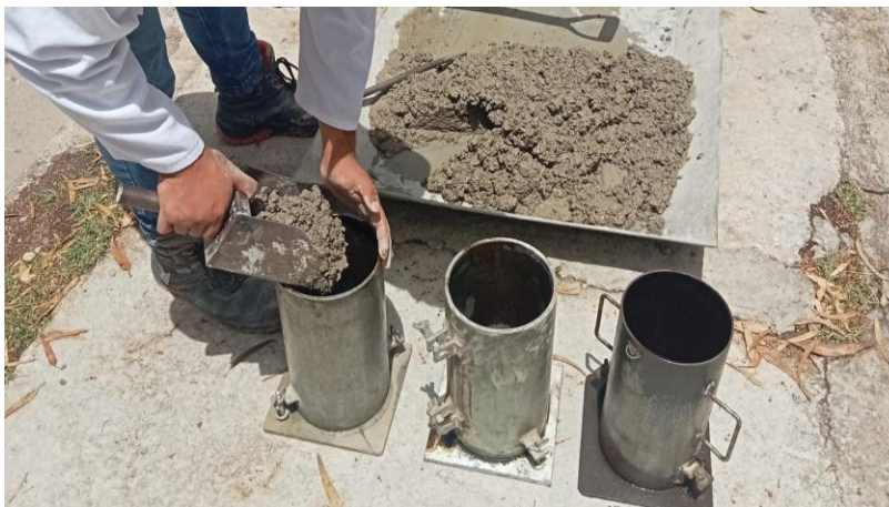
Figura 49.- Elaboración y curado (NMX-C-123-ONNCCE-2012).
