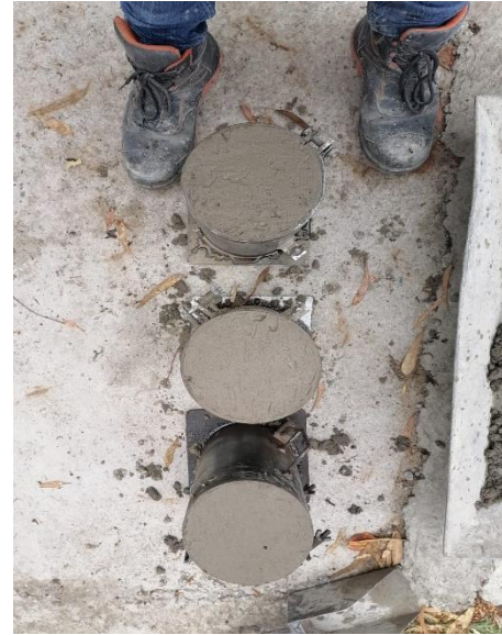
Figura 51.- Elaboración y curado (NMX-C-123-ONNCCE-2012).
