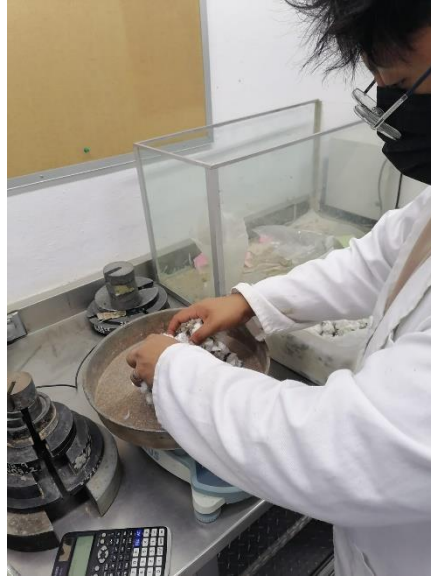
Figura 52.- Calculo y peso necesario para los cilindros de concreto.
