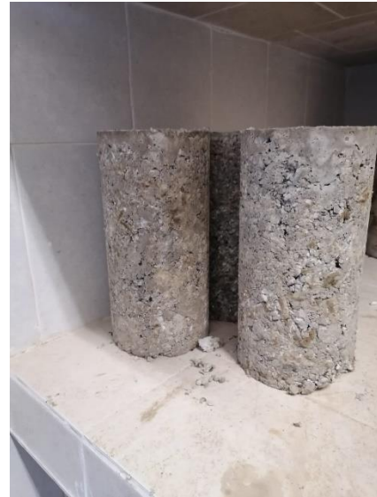
Figura 63.- Especímenes al 2% de colillas alterados.
