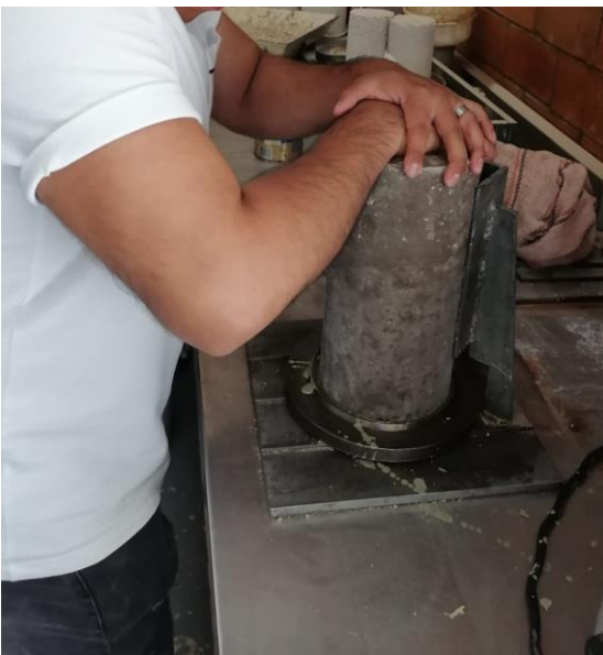
Figura 56.- Preparación y cabeceo (NMX-C-123-ONNCCE-2012).
