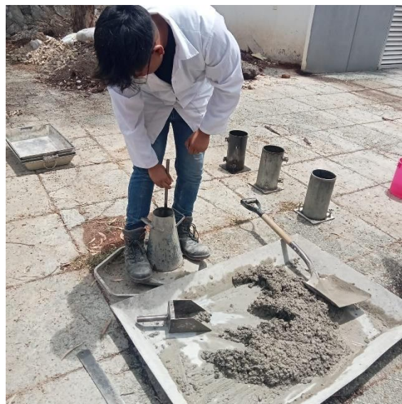
Figura 48.- Compactación del material en el cono.
