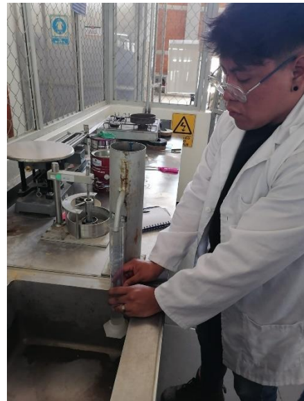
Figura 30.- Recolección de volumen expulsado del sifón.
