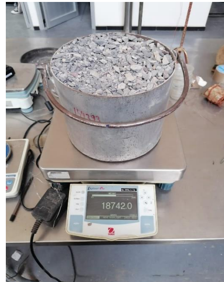
Figura 24.- Análisis para el peso volumétrico seco suelto (P.V.S.S).
