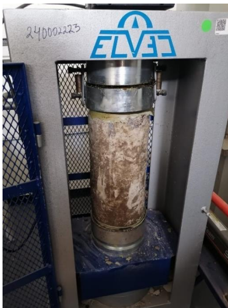
Figura 58.- Primer cilindro colocado en la prensa de compresión (NMX-C-083-ONNCCE-2014).
