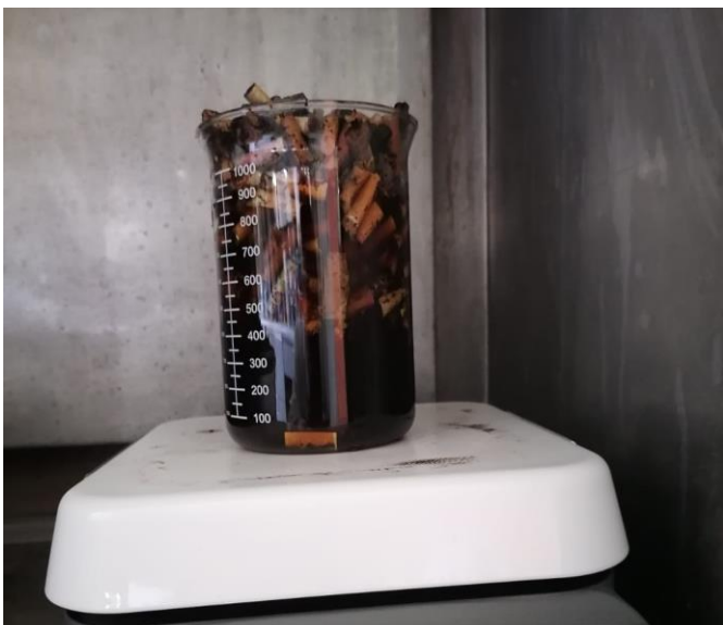
Figura 13.- Segundo lavado de las colillas de cigarro en agua destilada a temperatura ambiente. (Elaboración propia).
