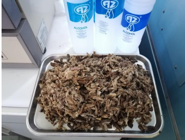
Figura 16.- Colillas limpias, extendidas creando filamentos finos para la dispersión del concreto (Elaboración propia)
