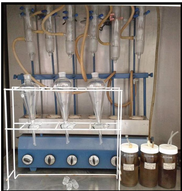
Fig.6. Extracción de HC por el método soxhlet.
