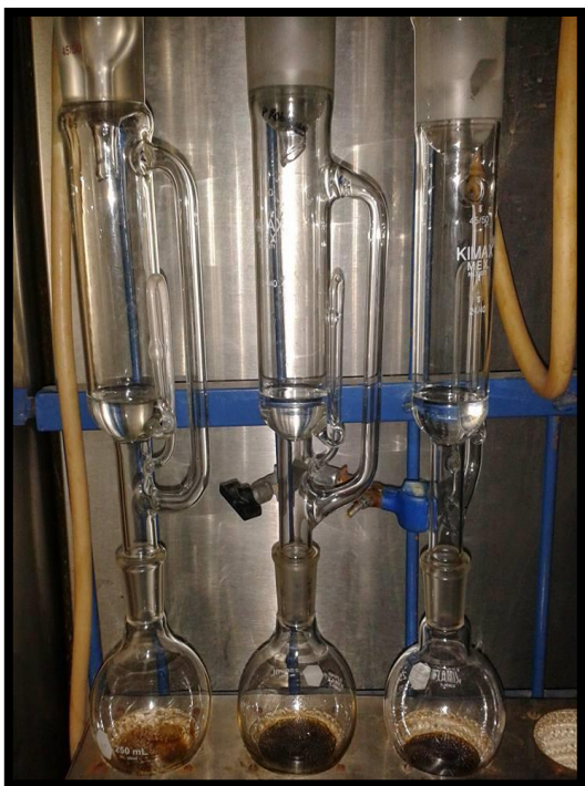
Fig.5. Extracción de HC por el método soxhlet.
