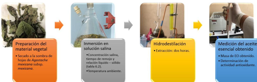
Figura 6.2 Procedimiento de extracción y medición del AMMEO
