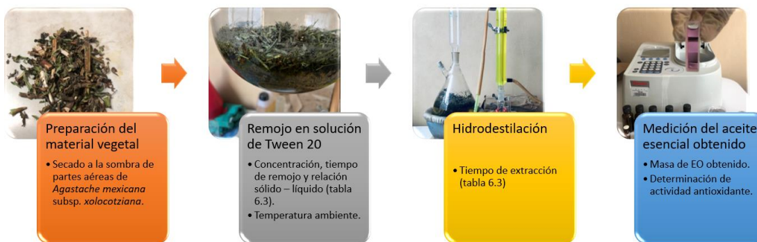
Figura 6.3 Procedimiento de extracción y medición del AMXEO
