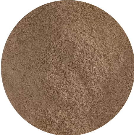
Figura 7. Anexo 2. Material menor a abertura de malla de 0.15 mm.
