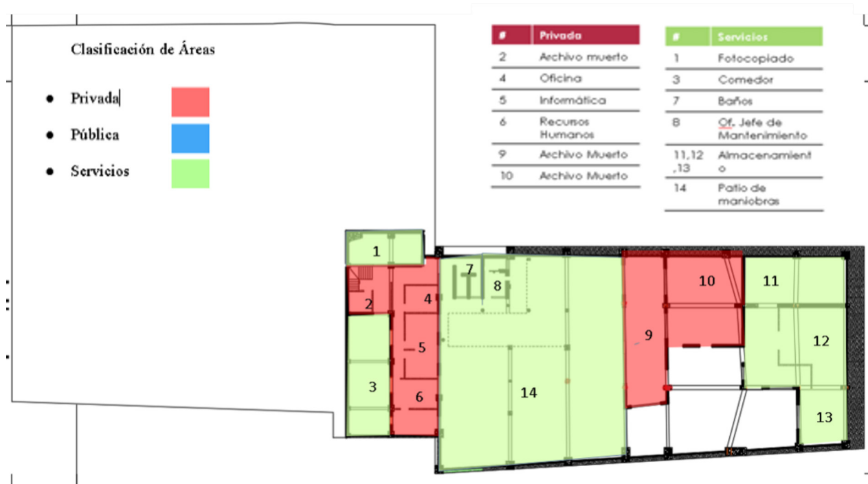
Figura 35: Plano arquitectónico-Sótano. Elaboró: Brenda Itzel Jiménez Vargas.
