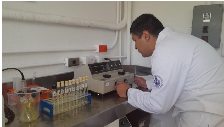
Fotografía 7. Lectura de muestras para determinación de nitratos mediante un espectrofotómetro de doble haz.
