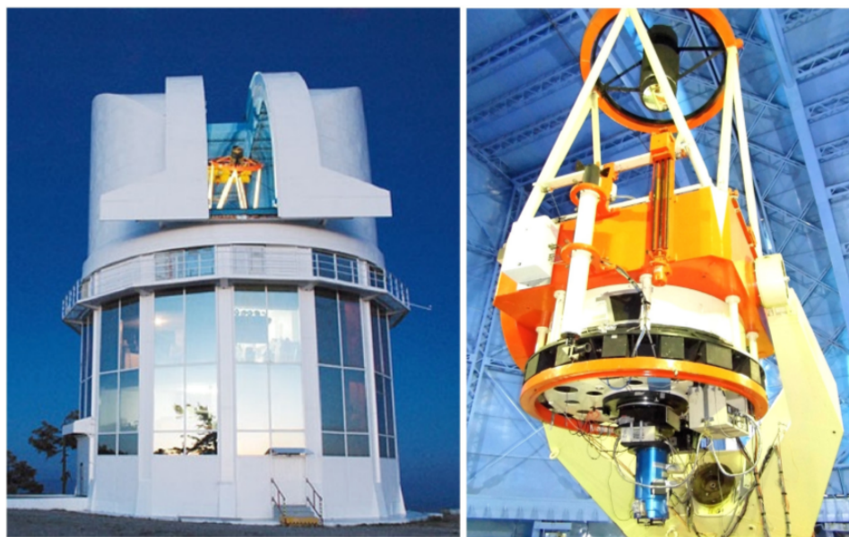
Figura 3.2: Observatorio Astronómico Guillermo Haro (OAGH); Cananea, Sonora. Izquierda: Vista exterior del observatorio. Derecha: Telescopio de 2.1 m con montura ecuatorial. Créditos: Carrasco et al. (2017)
