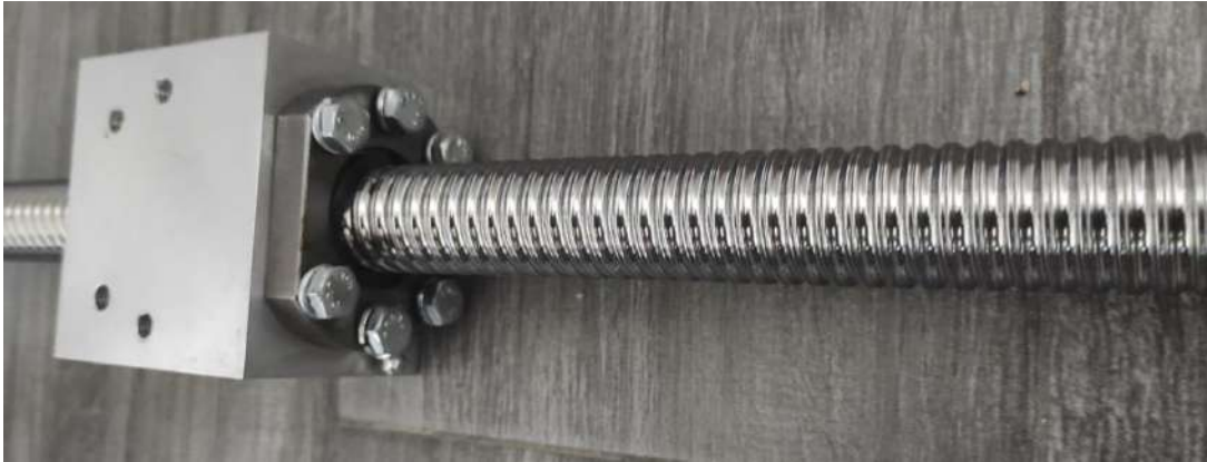
Figura 3.8 Montaje final para el acoplamiento entre el tornillo embalado y el bloque de desplazamiento
