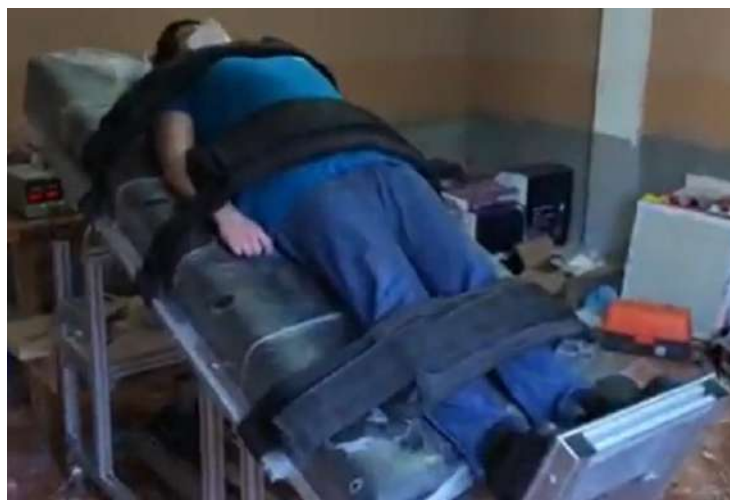
Figura 4.17 Funcionamiento de la mesa de inclinación con carga utilizando el nuevo sistema de potencia
