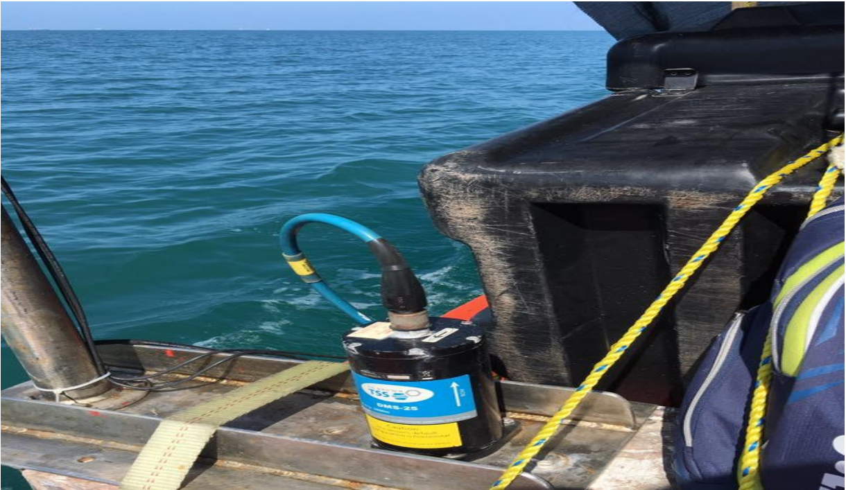
MRU. Sensor de movimiento (Compensador de movimiento Balanceo, Cabeceo y Rolido).
