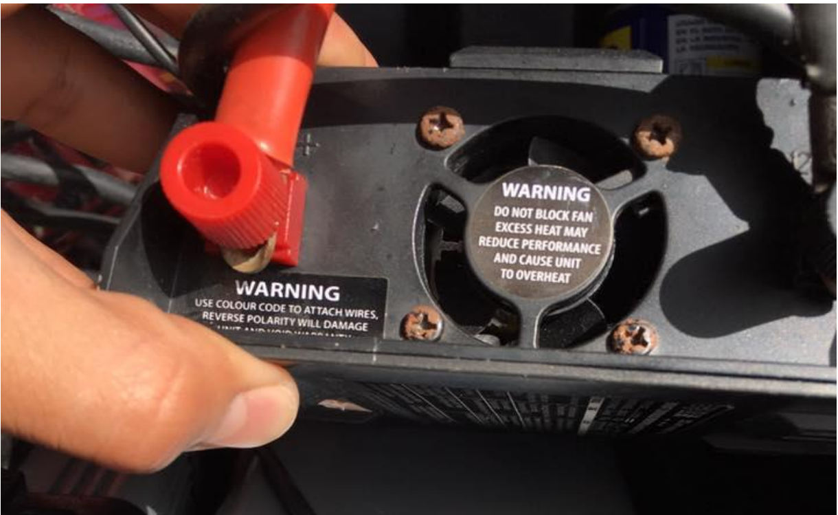
Inversor de corriente.
