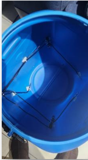
Instrumentación de sensores de pH y de temperatura en biodigestor
