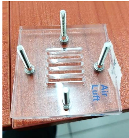
Figura 67. Placa plástica con orificios paralelos para flujo de oxígeno y pernos roscados metálicos. Fuente: Autoría propia.
