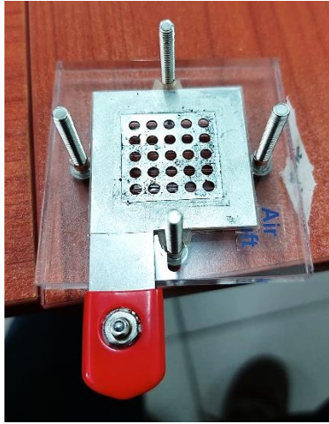
Figura 68. Placa colectora de corriente catódica con terminal positiva. Fuente: Autoría propia.
