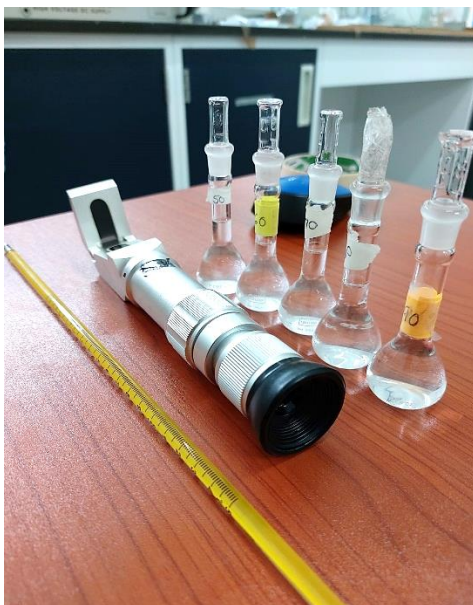
Figura 37. Refractómetro, matraces de aforo con diferentes concentraciones de etanol y termómetro de mercurio de 260°C. Fuente: Autoría propia
