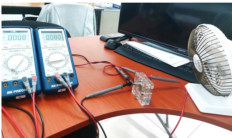
Figura 76. Sistema de detección de voltaje y corriente con ventilador suministrando aire a la CCED. Fuente: Autoría propia.
