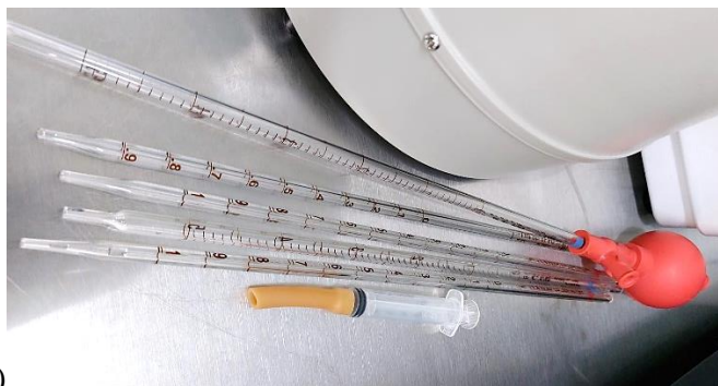
Figura 32. Proceso de llenado de cubetas de espectrofotometría. A) Utilización de pipeta en vasos de precipitado. B) Transporte de las sustancias de la pipeta a las cubetas de espectrofotometría. C) Llenado de cubetas. D) Pipetas utilizadas en el proceso y pera de succión. Fuente: Autoría propia.
