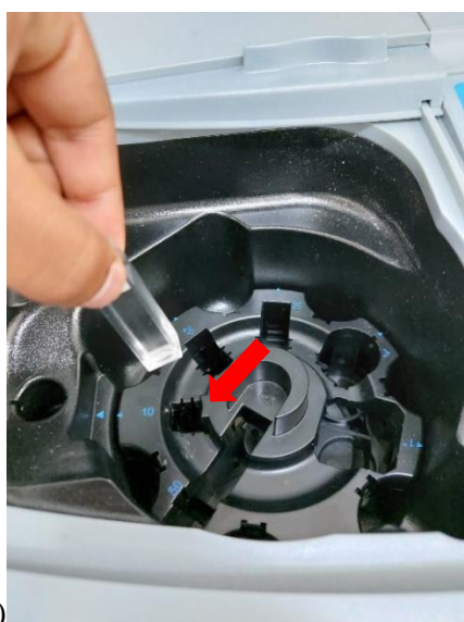
Figura 33. Colocación de la cubeta con las sustancias. A) Posicionamiento de la cubeta al espacio número 10 del espectrofotómetro HACH, señalado con la flecha roja. B) Cubeta posicionada correctamente. Fuente: Autoría propia.
