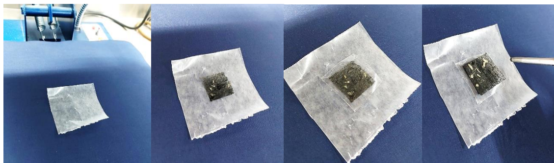
Figura 64. Secuencia de posicionamiento para el EME de N117 mediante prensa caliente. Fuente: Autoría propia.
