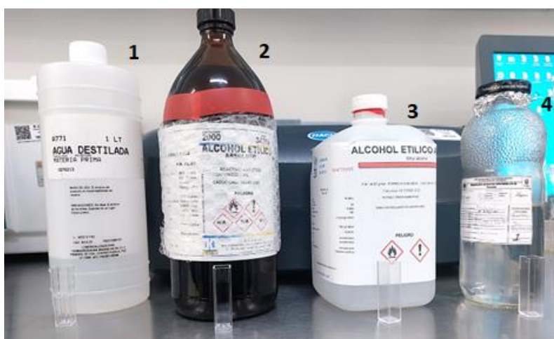
Figura 30. Materiales utilizados para el espectrofotómetro UV-Vis. 1) Agua destilada (cero), 2) Alcohol etílico 99%, 3) Alcohol etílico 70%, 4) Bioetanol colectado tercera destilación. Fuente: Autoría propia.
