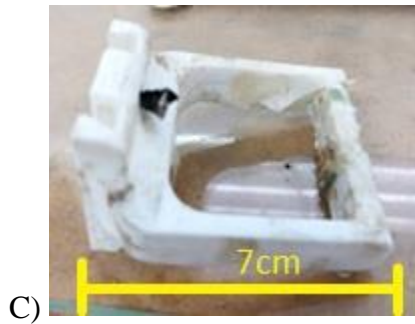
Figura 39. Componentes de la torre de soporte impresa en 3D. A) Base carril fija. B) Torre vertical con carril. C) Base para punta metálica capilar. Fuente: Autoría propia.
