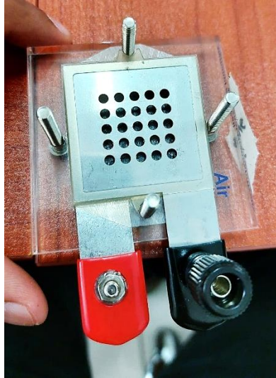
Figura 70. Ensamble con placa plástica, colector catódico, EME y colector anódico. Fuente: Autoría propia.
