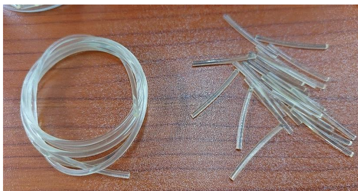
Figura 49. Filamento PVA (lado izquierdo), filamento PVA cortado (lado derecho). Fuente: Autoría propia.
