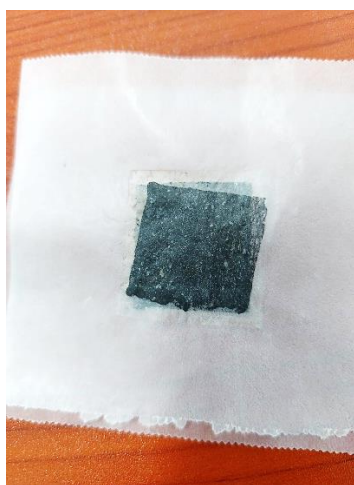
Figura 65. EME de E.L. con Memb. N117 mediante prensado caliente. Fuente: Autoría propia.
