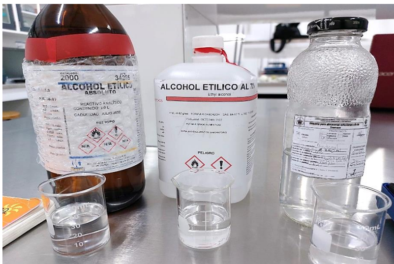
Figura 31. Vasos de precipitado de 50ml con 30ml de cada etanol. Fuente: Autoría propia.
