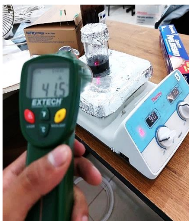
Figura 43. Pérdida de calor. Parrilla a 90°C, solución a 41.5°C. Fuente: Autoría propia.
