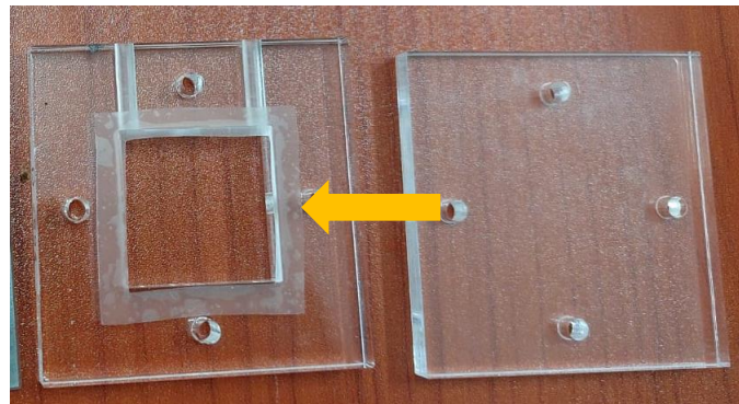
Figura 6. Platos de interconexión de una CCED, la flecha amarilla señala la película de silicón aislante. Fuente: Autoría propia.
