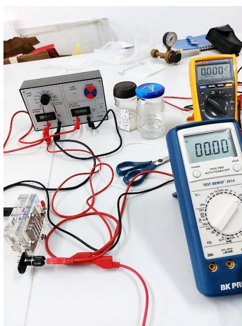
Figura 25. Dispositivos de detección de corriente y voltaje útiles para visualizar el comportamiento de una CCED. Fuente: Autoría propia.
