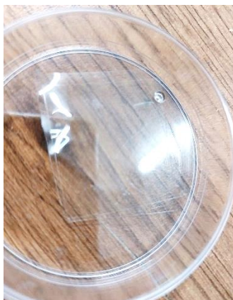
Figura 60. Almacenamiento de la membrana de Nafion® 117 en la caja de Petri y H 2 O desionizada para su posterior utilización. Fuente: Autoría propia.
