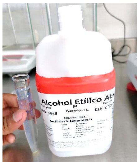
Figura 50. Alcohol utilizado para disolver el PVA y tubo de ensayo de 15ml utilizado para la adición a las soluciones. Fuente: Autoría propia.
