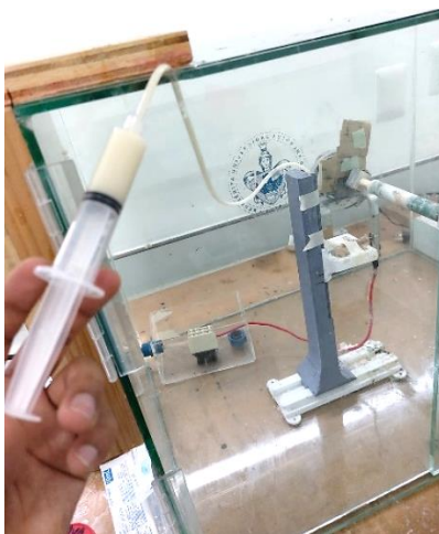
Figura 52. Inyección de la solución de PVA con material pulverizado desde la jeringa hasta la punta capilar metálica. Fuente: Autoría propia.
