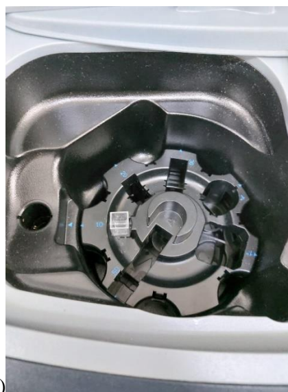
Figura 33. Colocación de la cubeta con las sustancias. A) Posicionamiento de la cubeta al espacio número 10 del espectrofotómetro HACH, señalado con la flecha roja. B) Cubeta posicionada correctamente. Fuente: Autoría propia.
